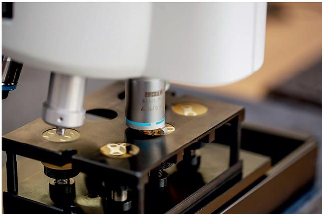
Bild 1. Die Härteprüfung an Kettengliedern wird mit der Mikrohärteprüfmaschine DuraScan 70 durchgeführt. © ZwickRoell
